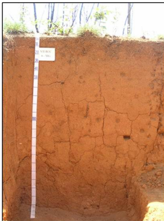
Figura 10 - Seção Transversal Típica de Latossolo Vermelho-Amarelo. FONTE: EMPRESA BRASILEIRA DE PESQUISA AGROPECUÁRIA – EMBRAPA.
